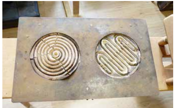
Električni kuhalnik brez zaščite. Kuhalna plošča je iz šamota, v katerega je navita spirala. V uporabi je bil še do leta 1970.
