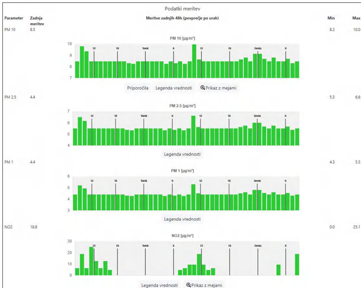
Slika 4: Primer prikaza rezultatov meritev na eni od merilnih postaj za zadnjih 48 ur za parametre PM 10 , PM 2,5 , PM 1 in NO 2 .
