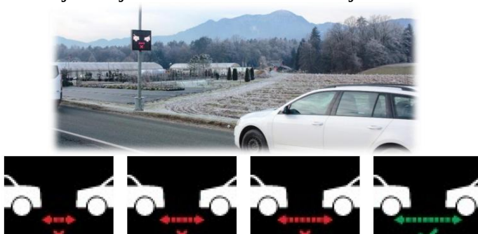
Slika 3: led prikazovalnik z detekcijsko enoto.
